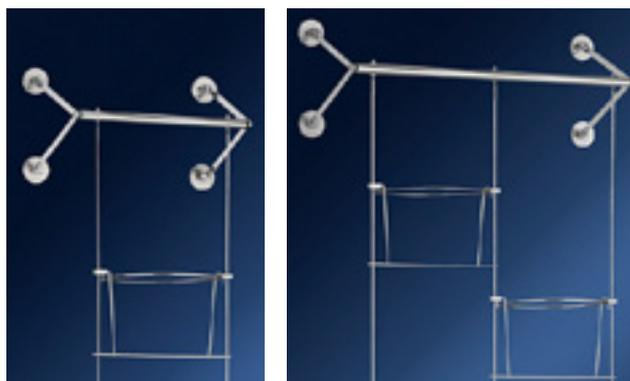
Die ASS Rohrtraversen weisen Bohrungen auf, die dem Rastermaß von 300 mm entsprechen. Diese sind für die Montage mit den Drahtkörben der ASS Hanging Baskets zwingend erforderlich. Die Laschen sind in verschiedenen Längen lieferbar, so dass eine Montage mit unterschiedlichen Wandabständen möglich ist. Wenn ASS Hanging Baskets vorgesehen sind, so müssen die ASS Rohrtraversen mit Laschen 200 mm befestigt werden, um einen ausreichenden Wandabstand zu gewährleisten.
