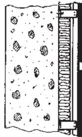
Beton mit Dämmung
