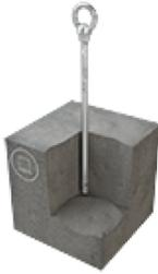
Einhämmern, Dübel spreizen, sofort einsatzbereit. Mit dem Personenanschlagpunkt ABS-Lock III-BE Pro wird die Montage von Absturzsicherungslösungen auf dem Flachdach noch einfacher. Denn die Verankerung im Beton benötigt nur ein Bohrloch. Der Spezialdübel des Edelstahl-Sekuranten wird vom Kopf aus mit einem Handgriff aufgespreizt. Ein Drehmomentschlüssel genügt.
