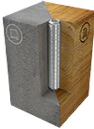
Die Edelstahleinbauhülse ABS-Lock II-B ist das Gegenstück zum abnehmbaren Anschlagpunkt ABS-Lock I. Die Hülse ist in variable Längen erhältlich und wird entweder in Beton eingeklebt oder in Holz geschraubt. Mit verschiedenen Winkелеlementen montieren Sie den ABS-Lock II-B problemlos in abgehängten Decken. Damit eignet sich das System hervorragend zur Fensterabsturzicherung. Der bündige Abschluss der Hülse mit der Decke sorgt für eine ungestörte Ästhetik in Ihren Räumen.
