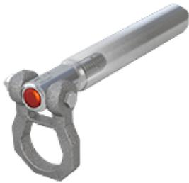
Das Prinzip hinter unserer Absturzsicherung ABS-Lock I+II lautet: Eine Anschlagöse für mehrere Anschlageneinrichtungen. Das System basiert auf 2 Elementen. Der ABS-Lock I ist ein abnehmbarer Anschlagpunkt, der mit einem Knopfdruck eingesetzt und ebenso unkompliziert wieder abgenommen wird. Sobald die Sperrkugeln des Anschlagpunkts arretieren, hält er problemlos Belastungen von 2 Tonnen und mehr stand. Er eignet sich damit bestens zur Fensterabsturzsicherung.
